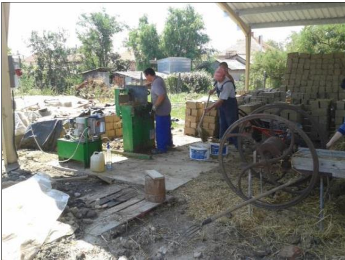
Közben folyamatos volt a vályogtéglagyártás egy már meglévő színelő
