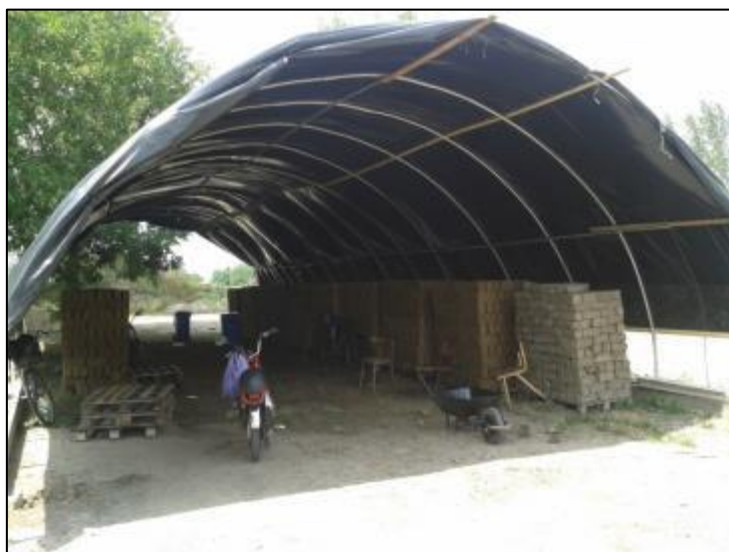
A kész téglák raklapokon az ideiglenes szárítószínben
