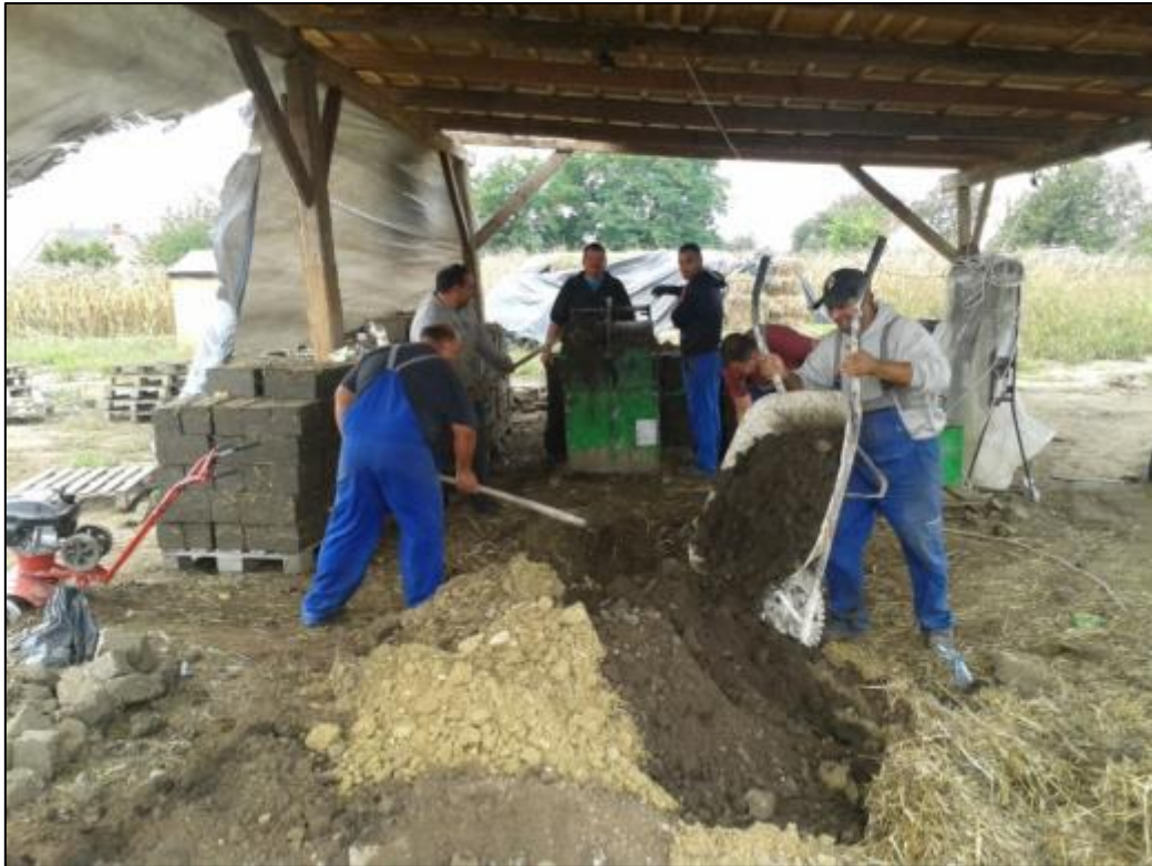
Anyag-előkészítés. Többféle föld, szalma és kevés víz keveréke az alapanyag.
