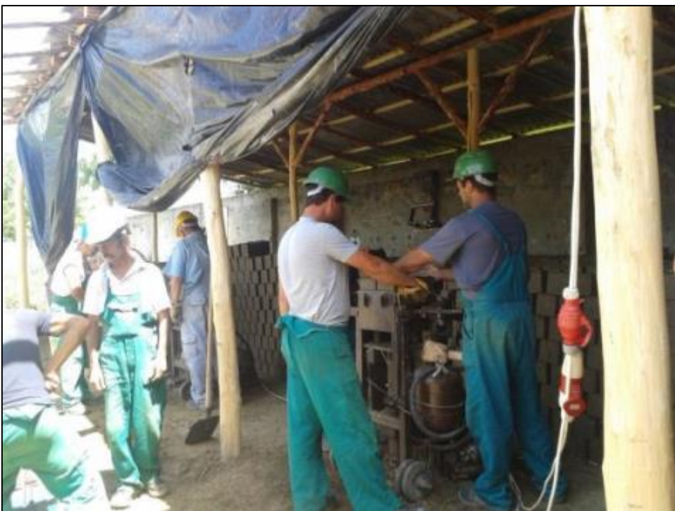
A vályogtéglák préselése
