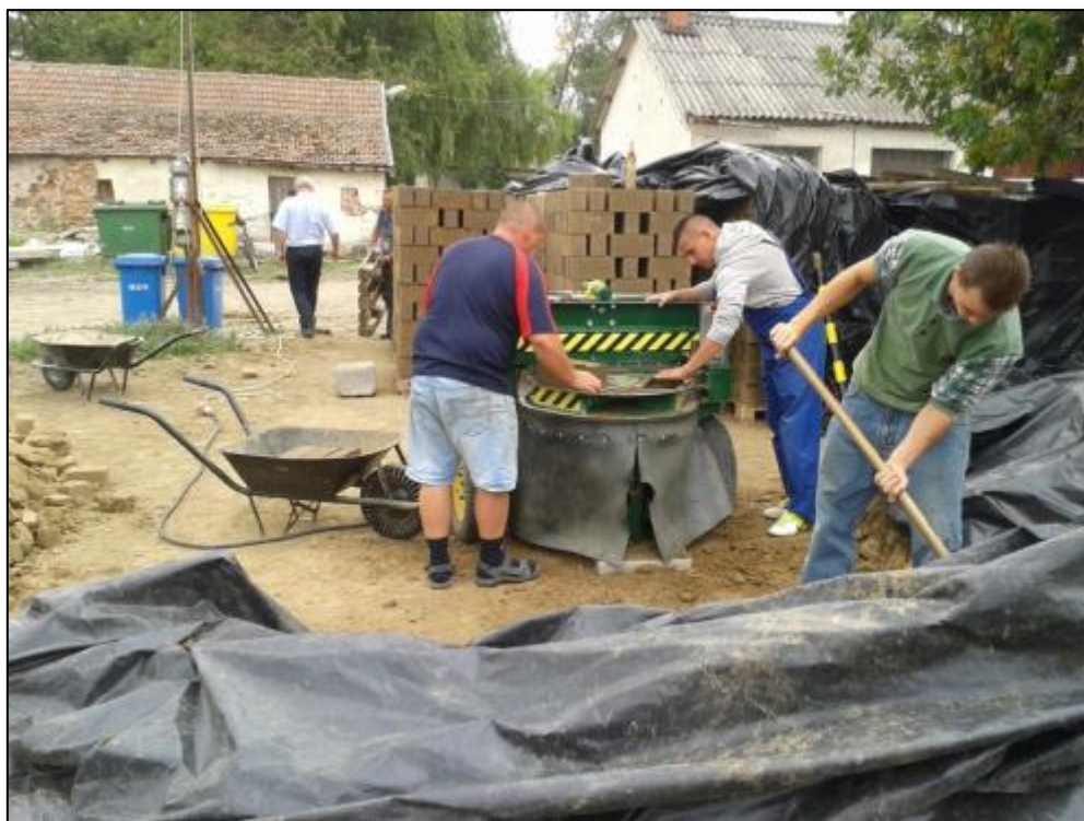
A téglagyártás: az egyik munkás tölti a sablont, a másik ugyanabban az ütemben elveszi a kész téglát
