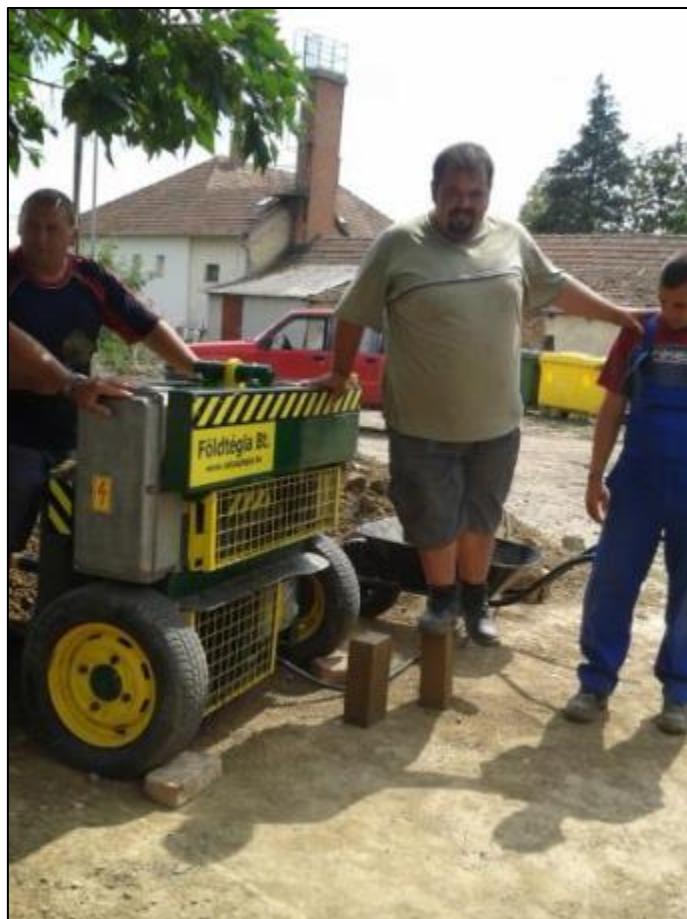
Próbaterhelés. Az eredmény jó. A földnedvesen préselt téglá nyers állapotban is elbírja egy ember súlyát
